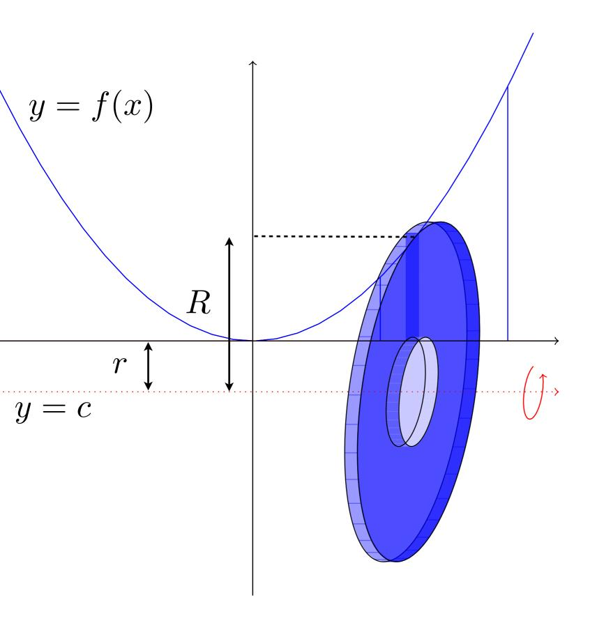
Volume d'un disque troué:  $\pi R^2 \Delta x - \pi r^2 \Delta x$
