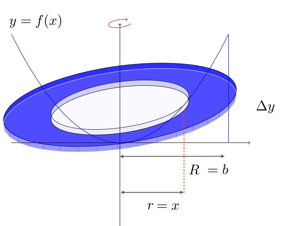
Volume d'un disque troué:  $\pi R^2 \Delta y - \pi r^2 \Delta y = \pi b^2 \Delta y - \pi x^2 \Delta y$
