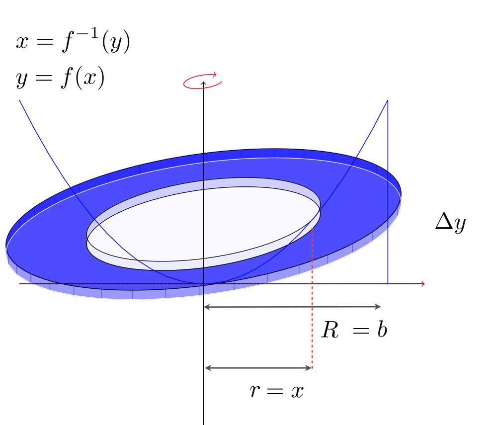
Volume d'un disque troué:  $\pi R^2 \Delta y - \pi r^2 \Delta y = \pi b^2 \Delta y - \pi x^2 \Delta y$
