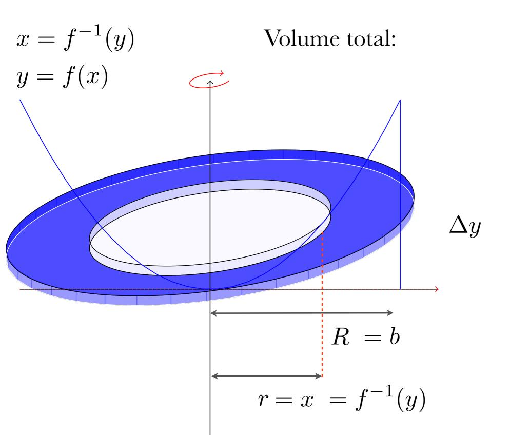
Volume d'un disque troué:  $\pi R^2 \Delta y - \pi r^2 \Delta y = \pi b^2 \Delta y - \pi x^2 \Delta y$   $= \pi b^2 \Delta y - \pi (f^{-1}(y))^2 \Delta y$
